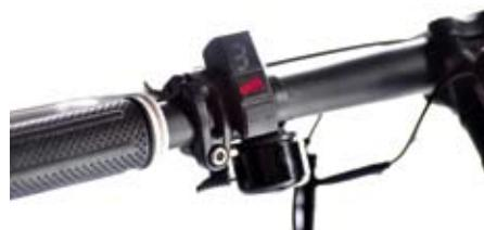
Der Schalter zum Ändern der Unterstützungsstufen ist unscheinbar und klein.
